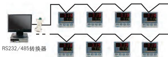
注：连线方式：每条线路可连 50—60 台仪表，必须采用 RS485 通讯专用双绞线或计算机连网的五类线（用其中一对即可）
