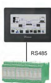
作为无纸记录仪和触摸屏控制系统的下位机使用
